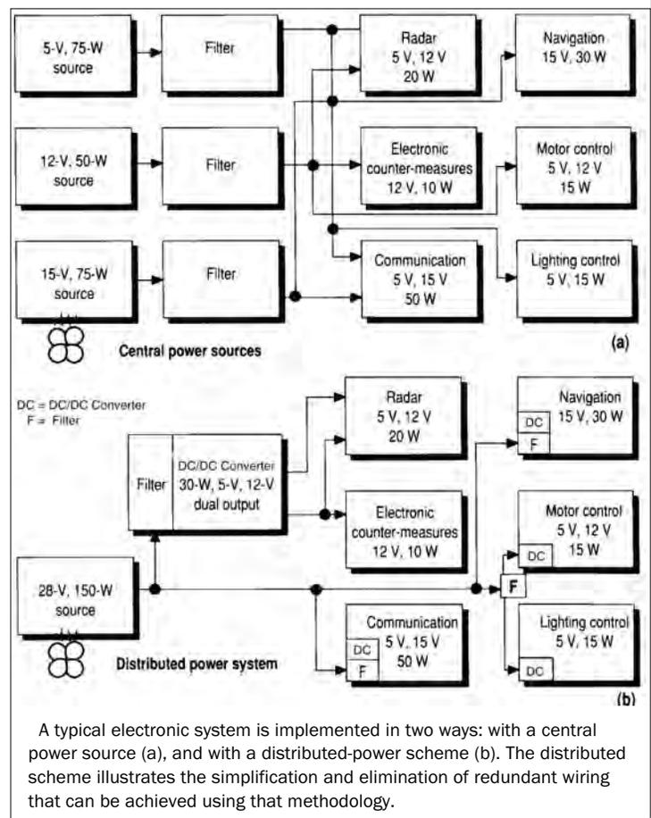
FIGURE 1: CENTRALIZED POWER VS. DISTRIBUTED POWER
