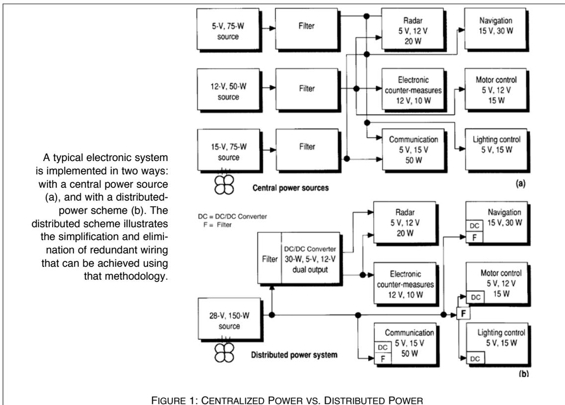
FIGURE 1: CENTRALIZED POWER VS. DISTRIBUTED POWER
