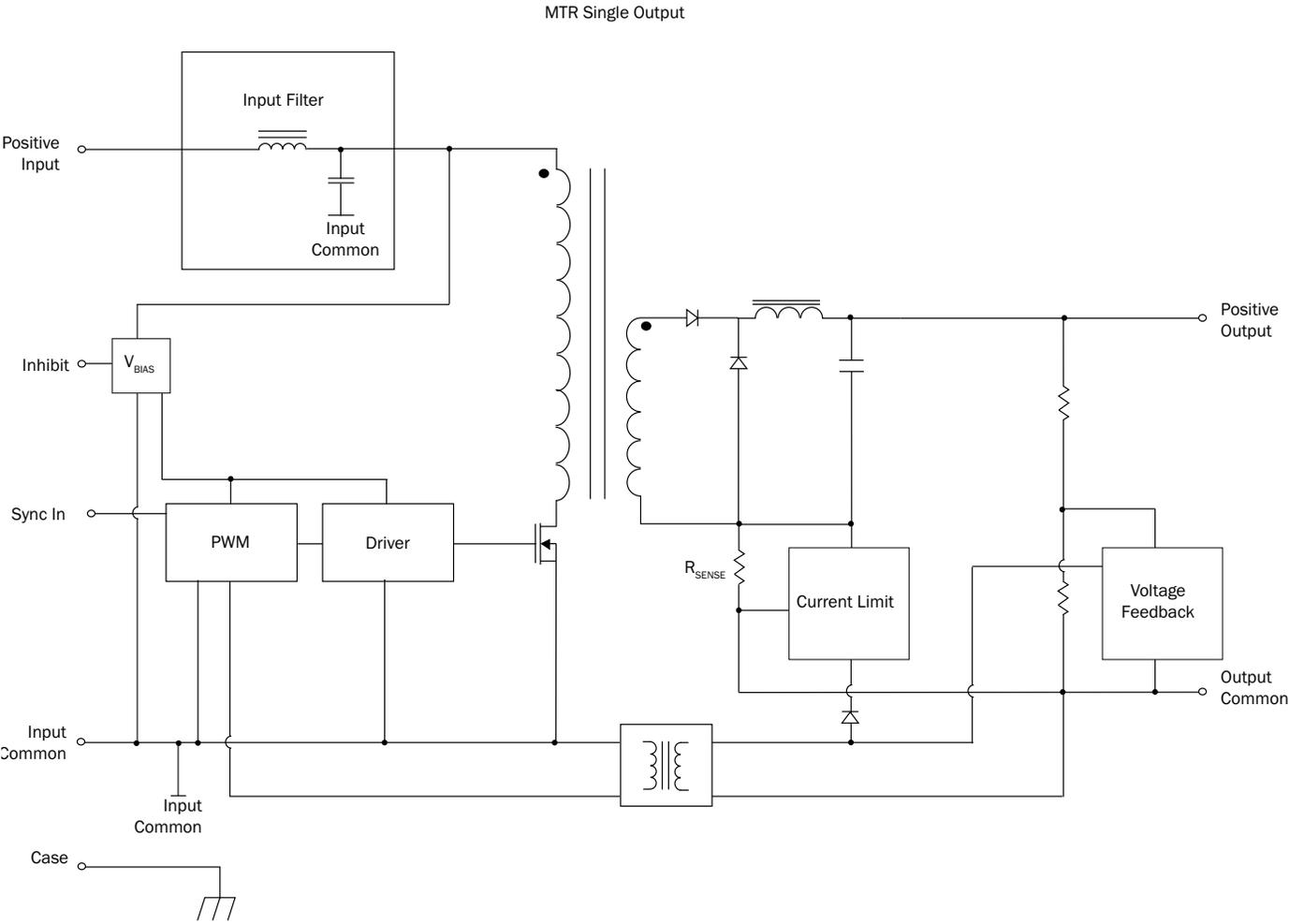
FIGURE 1: MTR SINGLE BLOCK DIAGRAM
